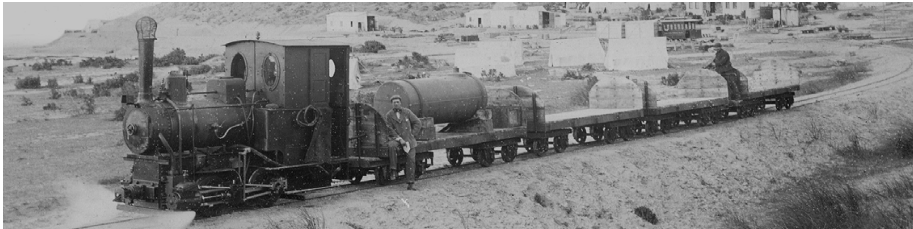
La Krauss 0-4-0T con un vagón para servicio de agua y tres plataformas vacías se dirige a las salinas.
